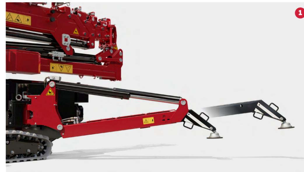
**1 Hydraulisch ausfahrbare Stützbeine**
